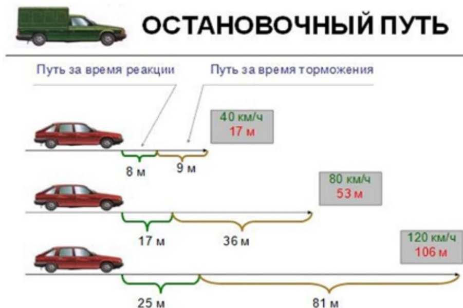
Рисунок 18. Составляющие остановочного пути
